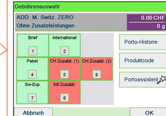
2. Mit den Tasten 1 bis 9 wählen Sie das Produkt und/oder verfügbaren Zusatzleistungen und erhalten Zugriff auf den Porto-Assistenten.
