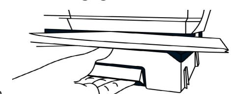
3. Reicht das nicht aus, heben Sie den Deckel der Zuführung an und drücken auf den oberen blauen Hebel, um den Schlitten anzuheben. Entnehmen Sie den eingeklemmten Umschlag und drücken Sie den Schlitten nach unten, um ihn wieder einzurasten.
